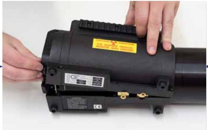
Retire un lado de la carcasa. Levante el conjunto del cabezal y la placa del oscilador. Al volver a ensamblar, asegúrese de que los insertos del trípode de latón y los terminales de la batería estén colocados correctamente.
