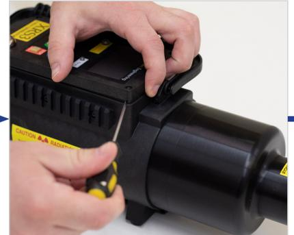
Haga palanca suavemente en la parte delantera del módulo de control con un destornillador plano.
