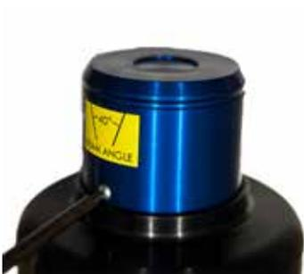
Con un destornillador T10, afloje con cuidado el tornillo lo suficiente como para que no deje cicatrices en la carcasa cuando se instale o retire la tapa.
