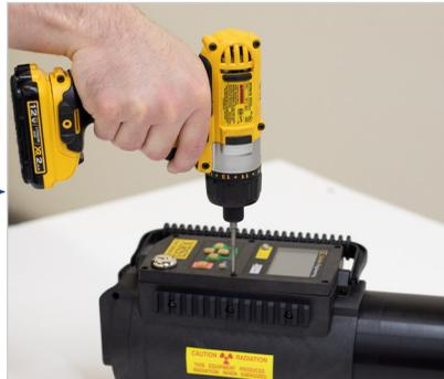
Con un destornillador para tornillos Torx T10 quite los 6 tornillos que conectan al módulo de control.
