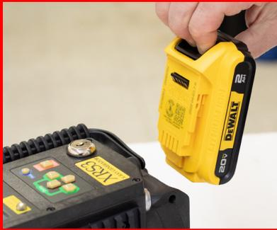
1. Extraiga la batería antes de remover el colimador.
