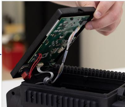
Incline la placa hacia la batería para exponer los cables.
