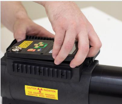
Levante la placa superior de la parte delantera del generador
