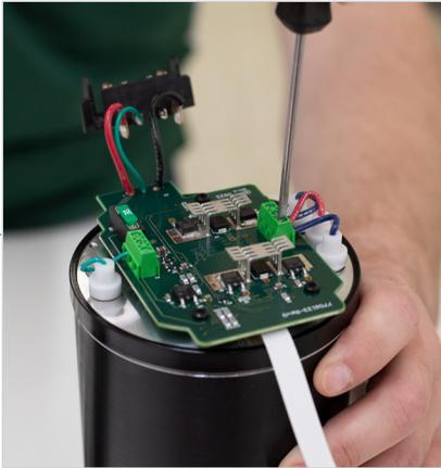
Afloje los cuatro tornillos que sujetan los cables de paso en su lugar.
