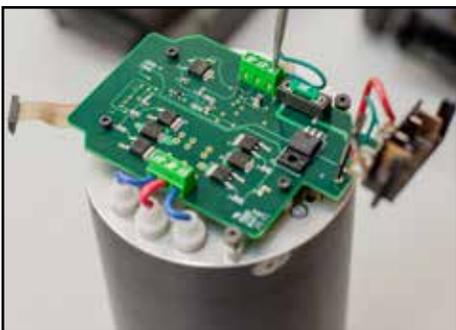
Afloje los 4 tornillos que sujetan los cables de realimentación.
