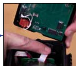
Módulo de control separado del generador
