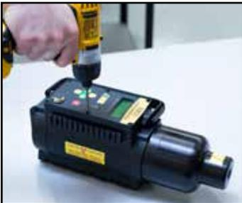
Levante al módulo de control para ver los cables de conexión.
