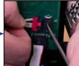
Los generadores con cables con 7 pines tienen **una conexión negra**. Tire suavemente a la conexión y hacia afuera.
