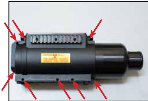
Quite los tornillos que sujetan la carcasa. Tanto el XR200 como el XRS3 tienen 8 tornillos; el XRS4 tiene 7 tornillos en la parte principal, y 8 más en la manija.
