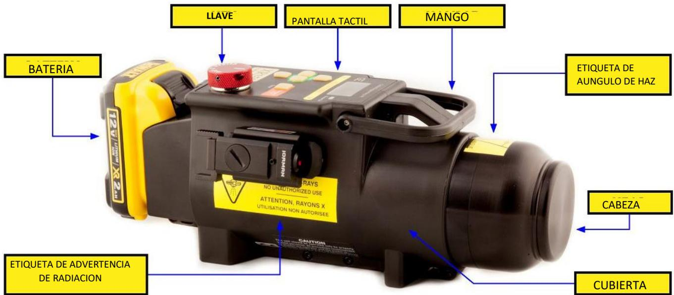
**PULSADOR DE ALTO VOLTAJE/CABEZAL DEL TUBO** el cabezal de alto voltaje de la XR150 contiene el tubo de rayos-x estilo cátodo frío, el entrehierro, el capacitor de alto voltaje, el transformador, y el colimador de 40 grados.
